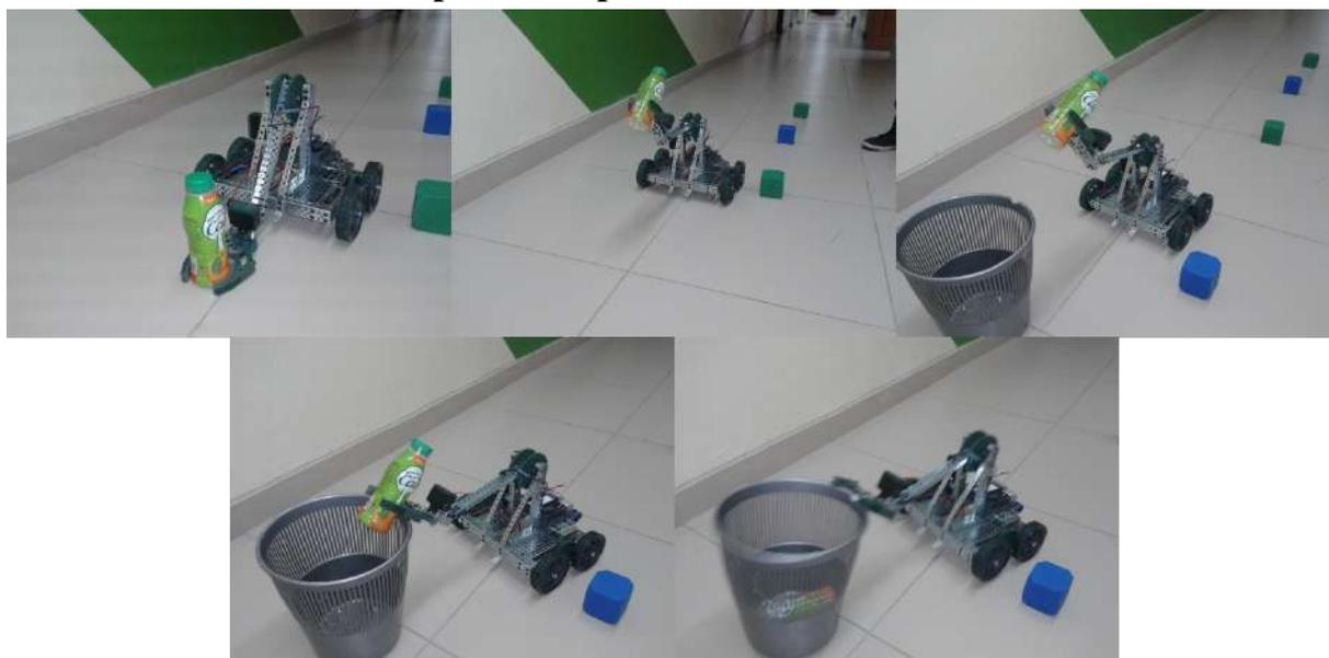
Захват небольшого предмета (пустой пластиковой бутылки) и перемещение ее в другое место (урну)
